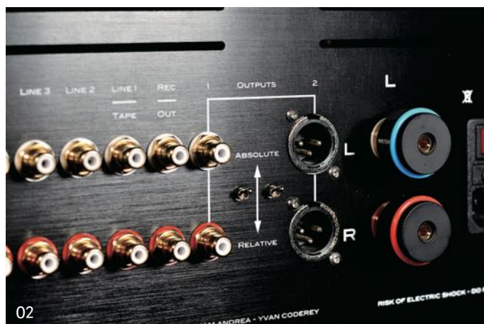
01、02. AL432H具备4组RCA输入和2组XLR平衡输入，REC输出、RCA与XLR前级输出 03. 沉甸甸的金属遥控器，手感不错
